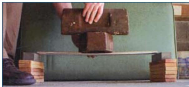
3) Introduire le cylindre en bois dans le deuxième cylindre en fer puis disposez l'ensemble sur les deux piles de briques écartées l'une de l'autre. Posez le poids au centre de l'ensemble cylindre en bois/tuyau en fer. L'ensemble ne cède pas !
