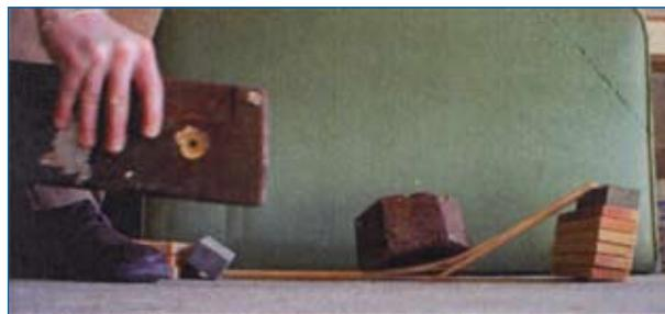
2) Disposez le cylindre en bois sur les piles de briques écartées l'une de l'autre. Posez le poids au centre du cylindre. Le cylindre en bois se casse !
