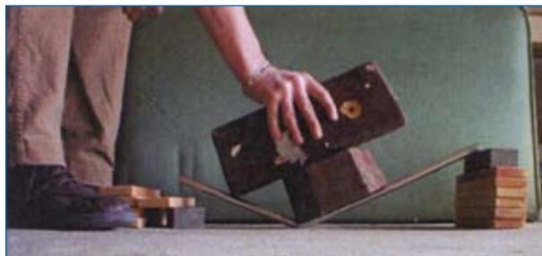
1) Disposez le premier tuyau en fer sur les deux piles de briques écartées l'une de l'autre. Posez le poids au centre du tuyau. Le tuyau cède !
